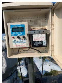
拍動自動灌水装置：太陽光パネルを 電源に晴れた日だけ、指定した分量 だけ自動的に灌水されます。
